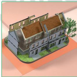
Nous procédons à la modélisation de chaque logement de la cité. Avec une précision au millimètre, notre rendu 3D nous permet de réaliser le calepinage nécessaire à la mise en production des manteaux **BLOKK**®.
